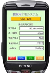
送信先PLC設定画面
