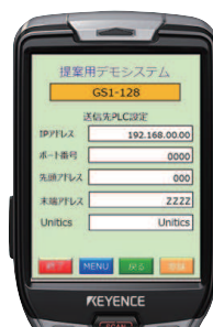
送信先PLC設定画面
